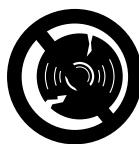
Inspeccione el disco abrasivo con frecuencia y sustitúyalo de inmediato si tiene roturas o combaduras. Los discos rotos o combados pueden romperse o quebrarse y causar lesiones personales graves o mortales. Los discos abrasivos deformados o desequilibrados pueden aumentar las vibraciones y acortar la vida útil de la tronzadora.
