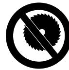
Nunca use discos de sierra circular, discos con puntas de carburo, discos reconstruidos, discos abrasivos para madera ni discos con dientes de tipo alguno. Pueden causar lesiones personales graves como resultado del contacto con el disco de sierra o los objetos lanzados y / o las fuerzas reactivas, incluyendo el contragolpe. Vea la sección "Fuerzas reactivas". El concesionario STIHL tiene un inventario de discos abrasivos especiales para los diversos usos de la tronzadora.
